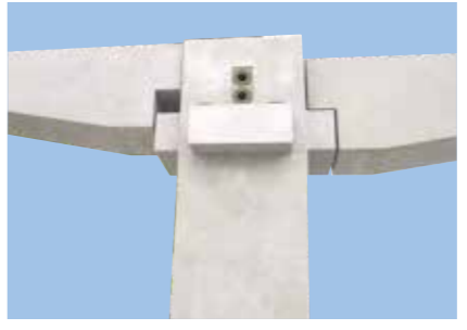
※ PC圧着関節工法®は、あごを有する柱・梁をPC鋼材で圧着する技術です。
